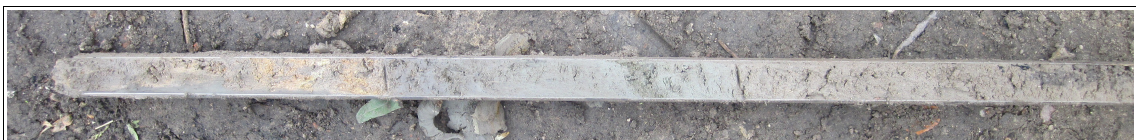
Figuur 10: Noordhorn, Langestraat 66: Gutsmonster boring 1 van 100 tot 190 centimeter. Van links naar rechts zijn drie lagen zichtbaar die in de guts ongeveer dezelfde dikte hebben. Van links naar rechts zijn dit: keileem, natuurlijke zeelei en opgebrachte homogene klei.
