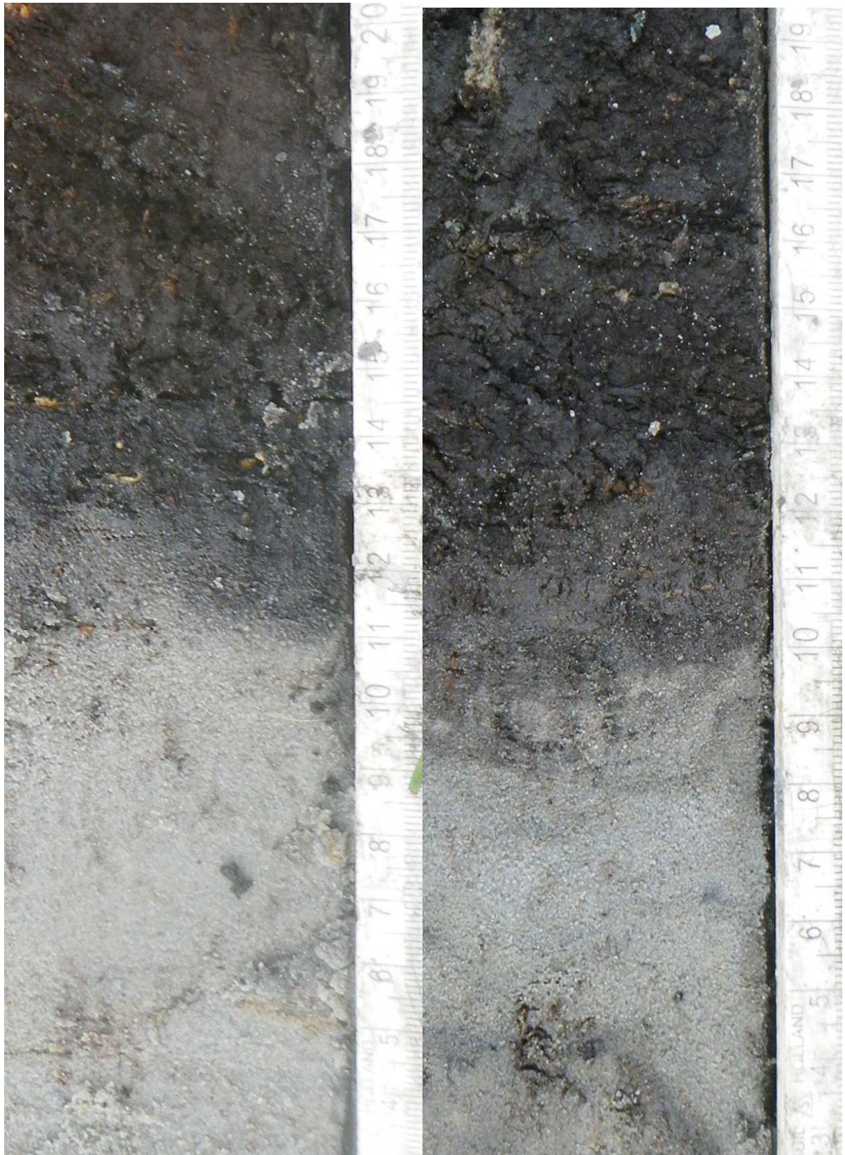
Figuur 9: Detail van de overgang van zand naar bovenliggend veen in de boringen 3 (links) en 2 (rechts).
