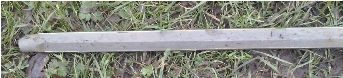
Figuur 6: Kesteren, Batterijenweg 19. Foto van boring 2 met de komklei die in alle boringen is aangetroffen.
