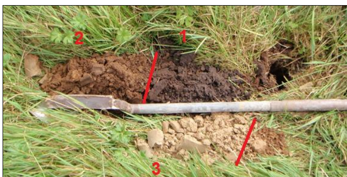
Afbeelding 6. Foto van boring 12. 1: bouwvoor, 2: B-horizont, 3: C-horizont
