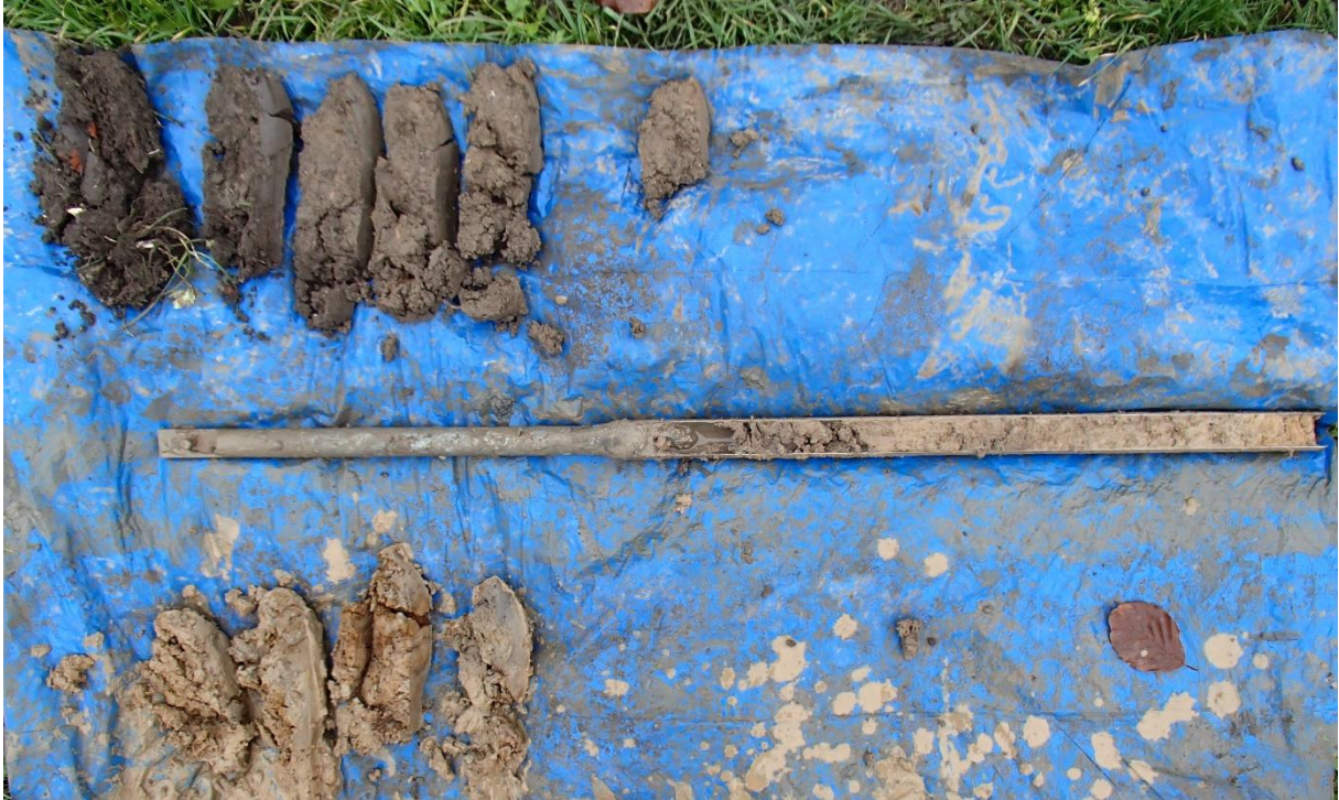
Boring 3: 0-150 cm -Mv. Bovenste rij boorkernen 0-60 cm -Mv, guts 60-100 cm -Mv, onderste rij boorkernen 100-150 cm -Mv.
