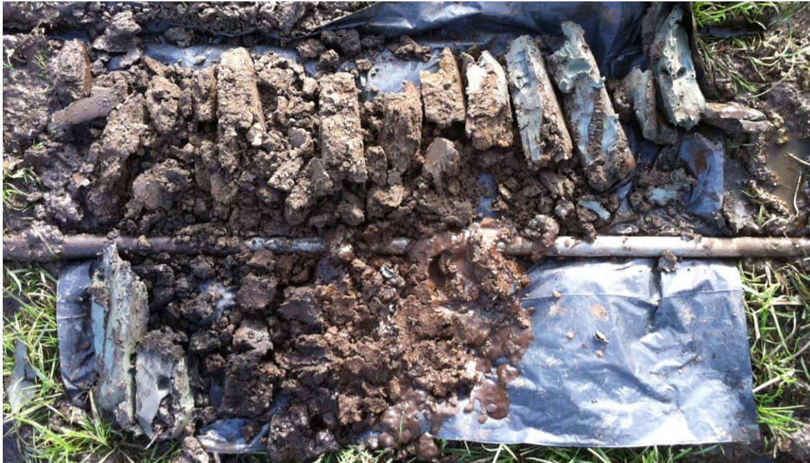
Boring 1: totaaloverzicht boorkernen
