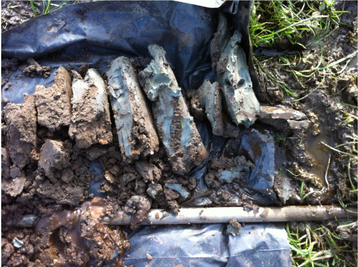
Boring 1: siltige blauwgrijze knipklei
