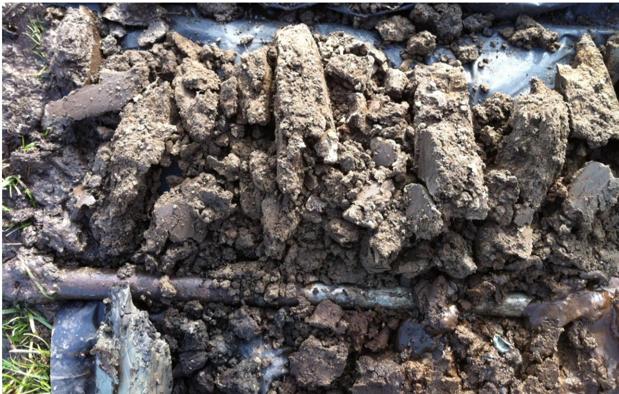
Boring 1: detailopname (zandige klei; ophoging)
