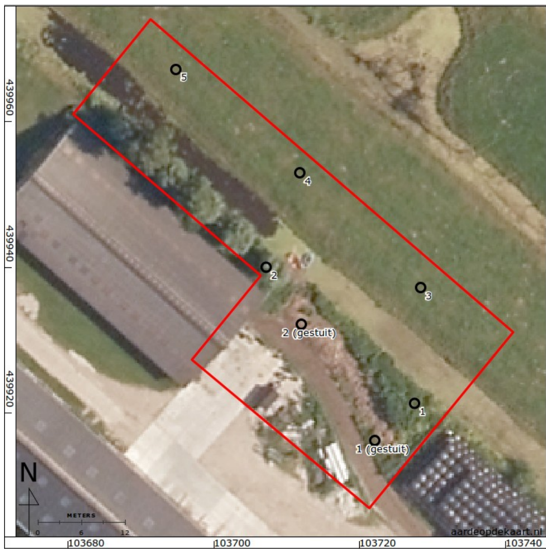
Figuur 20: Boorpuntenkaart op luchtfoto. Van boringen 1 en 2 is zowel de locatie waar de boringen zijn gestuit weergegeven, als de positie waar ze naar toe zijn verplaatst.
