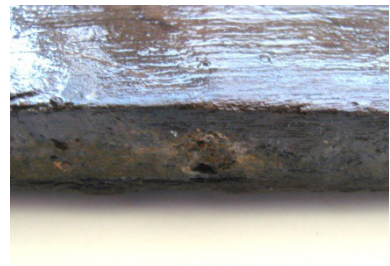
Figuur 24. Farmsum, Kloosterlaan: Een eikenhouten middenstuk uit een bodem van een vat (vnr. 12-1). Rechts een detailopname van de lange, smalle zijde, waarin een deuvel aanwezig is.
