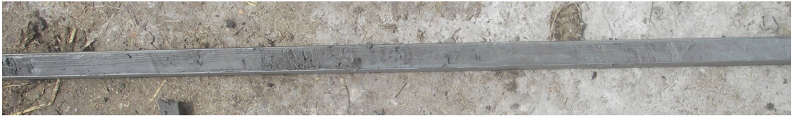
Figuur 6. Ginum, Roordastrjitte 7. Het pakket matig slappe, door enkele zandlaagjes onderbroken klei zoals dat onderin de boringen is aangetroffen.
