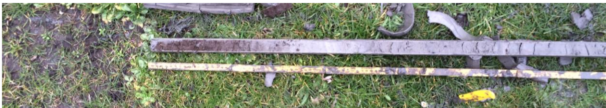
Boring 7: overgang van Hollandveen naar Duinkerke 1 afzettingen op 5,78 m –Mv
