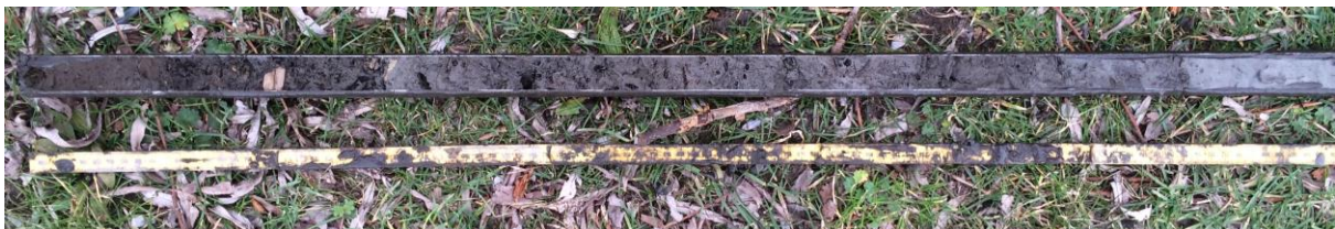
Boring 5: overgang van Hollandveen naar Duinkerke 1 afzettingen op 5,73 m –Mv
