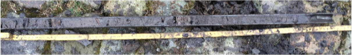
Boring 1: Duinkerke 1 afzettingen met houtresten op 4,0 – 5,0 m -Mv
