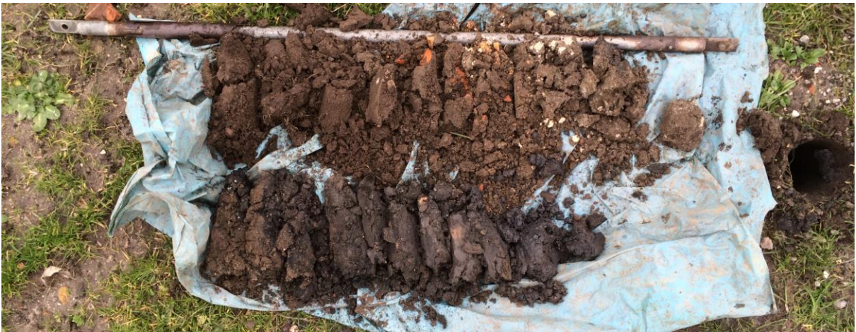
Boring 3: overzicht bovenste 2,0 m met ophogingslagen
