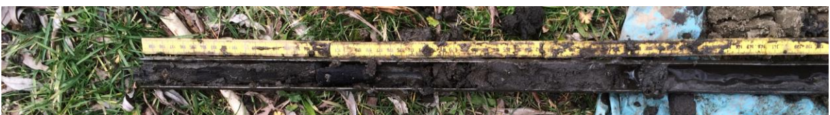
Boring 5: boring in oude paal op circa 3,00 en 3,30 m -Mv
