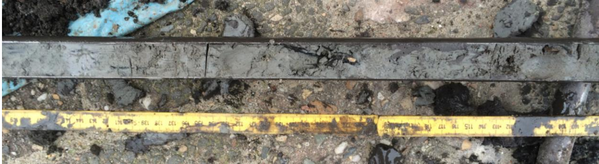
Boring 8: rommelige top Duinkerke 3 met verbrand riet in de Duinkerke 1
