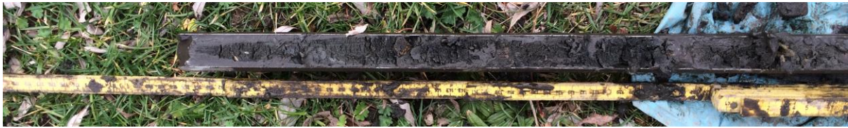
Boring 5: ophooglaag waarin tussen circa 3,4 en 3,7 m –M een kersenpit en slak (posthoornslak) zijn gevonden
