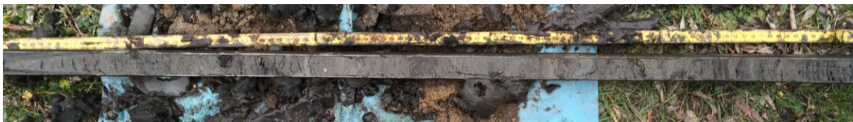
Boring 5: sterk gelaagde Duinkerke 1 geulafzettingen tussen 3,66 en 4,0 m -Mv
