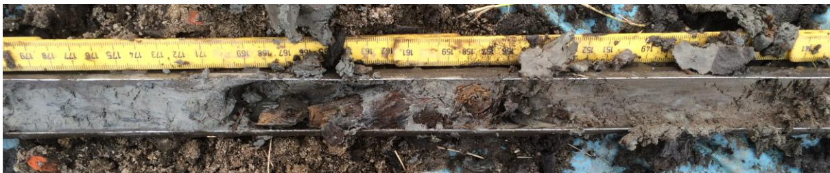
Boring 9: boring door bewerkte paal in top Duinkerke 3 op 2,56 – 2,64 m –Mv
