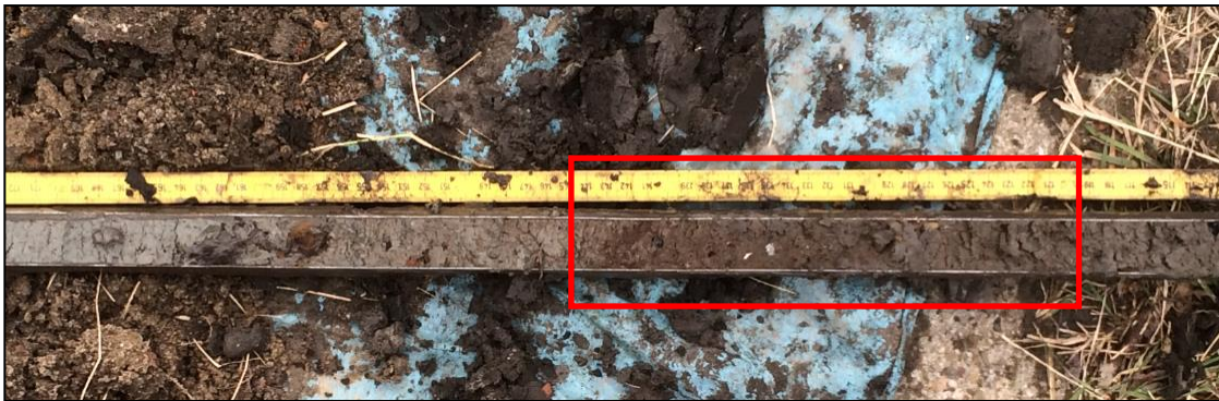
Figuur 26: De oudst aangetroffen ophooglaag (in het rode vak) in het plangebied, boring 9.
