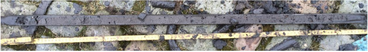
Boring 1: Duinkerke 1 afzettingen op 3,0 – 4,0 m -Mv
