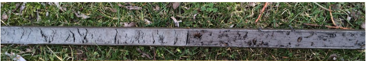
Boring 4: overgang van Duinkerke 1 naar Duinkerke 3 afzettingen.
