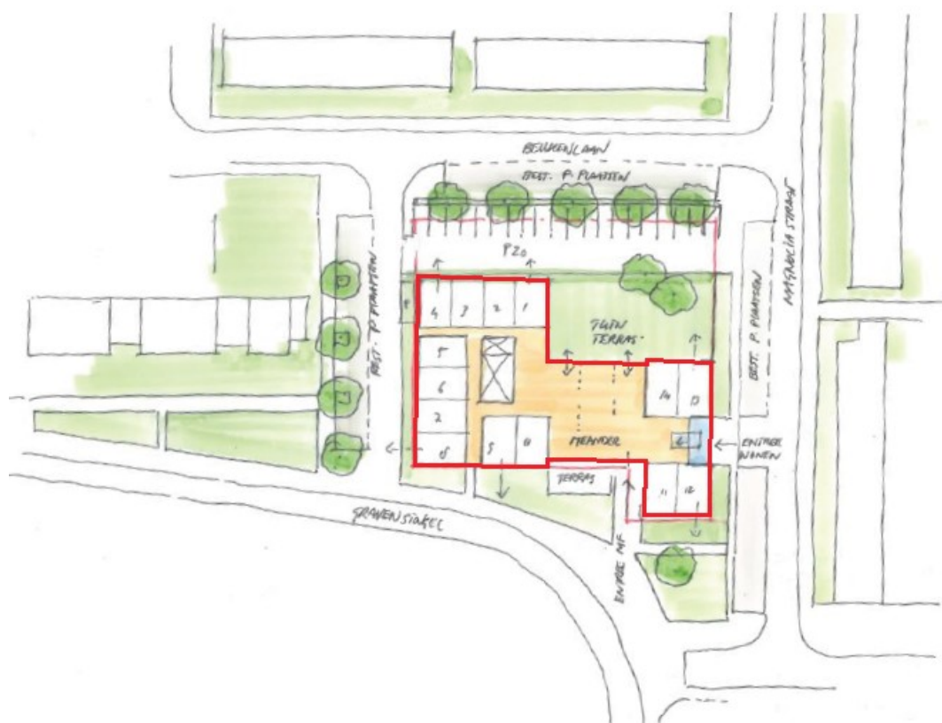
Figuur 3: Ontwerptekening van de begane grond van het nieuwe appartementengebouw. De nieuwe bebouwing is met de rode lijn weergegeven. Deze afbeelding is zuidgericht.
