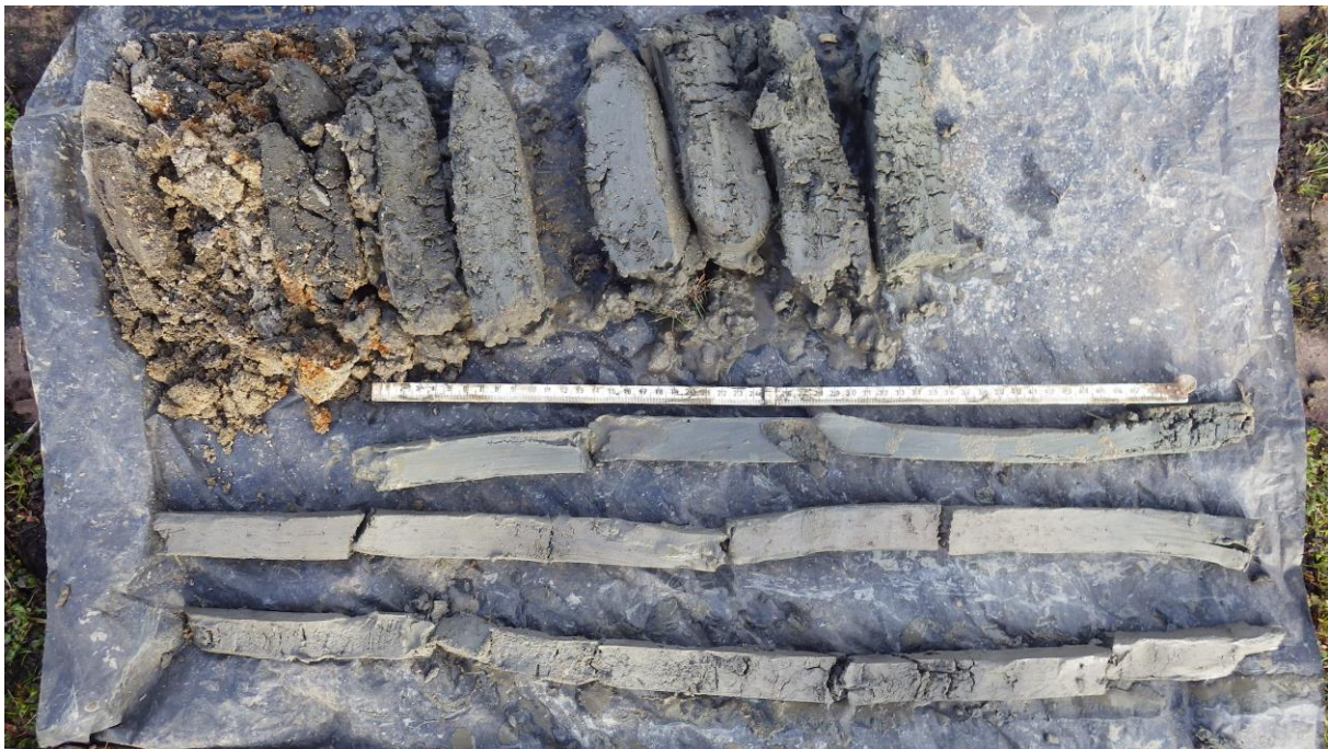
Boring 7: totaaloverzicht boorkernen
