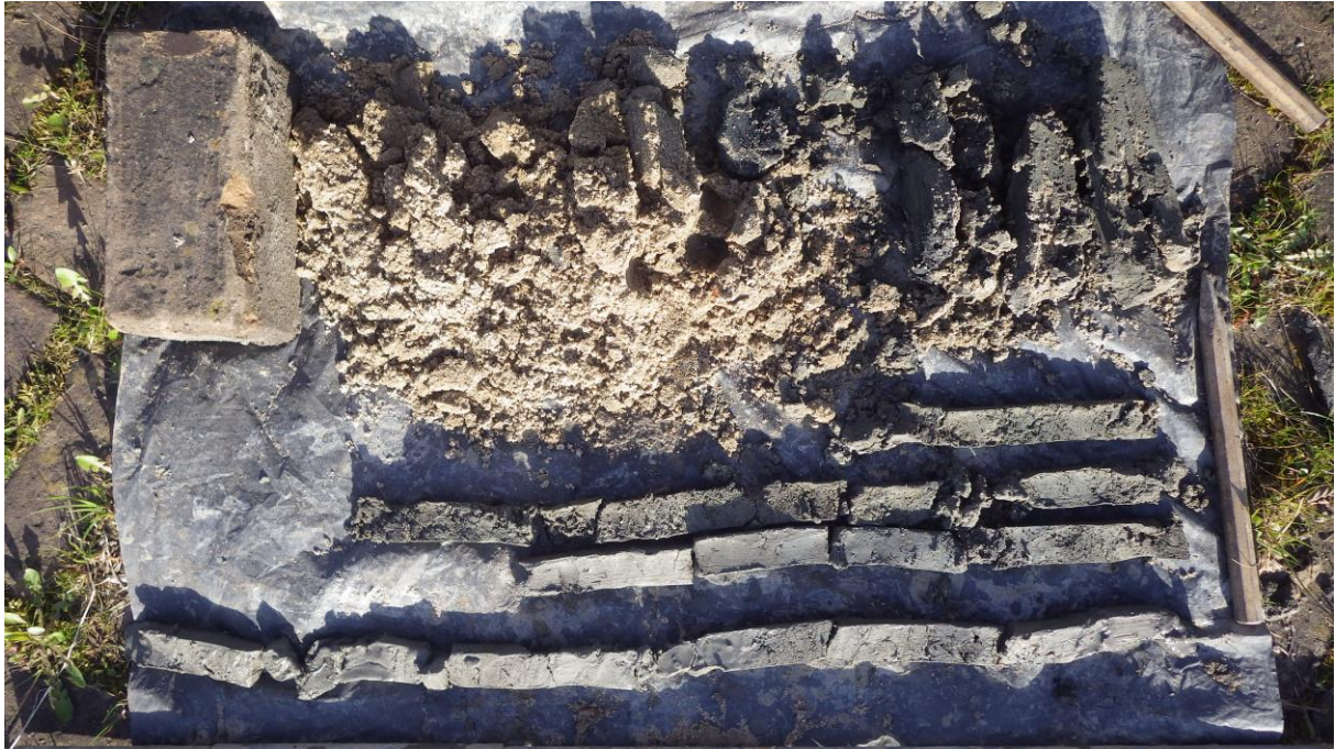
Boring 8: totaaloverzicht boorkernen
