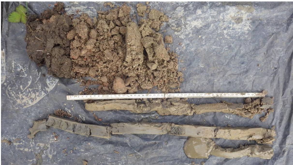
Boring 3: totaaloverzicht boorkernen
