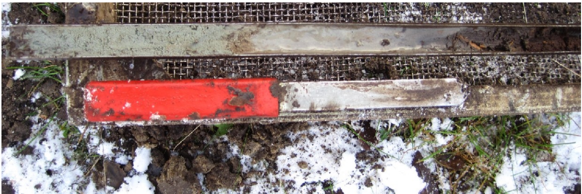
Figuur 10: Drachten, Raai / Zuiderdwarsvaart. Foto van boring 6 tussen 155 (rechts) en 195 (links) centimeter diepte; het gutsmes heeft een lengte van 25 centimeter. Links is keileem te zien, gevolgd door zand. Hierboven (rechts) is de overgang van zand naar veen zichtbaar.
