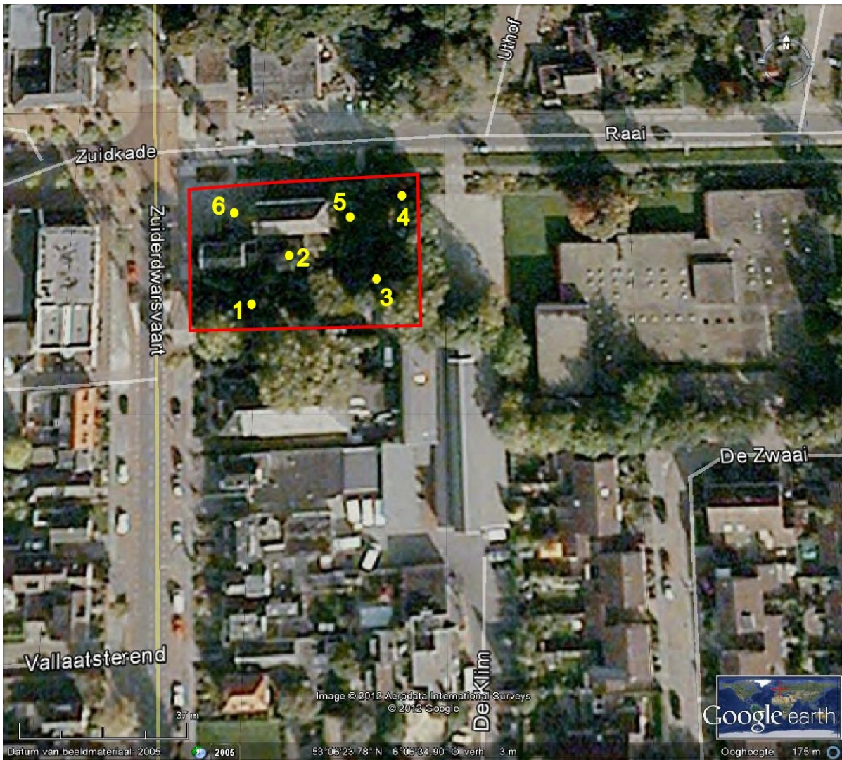
Figuur 9: Drachten, Raai / Zuiderdwarsvaart. Situatietekening met de boorlocaties. Het plangebied is weergegeven met een rode lijn. De beide gebouwen, waarvan ten tijde van het booronderzoek de meest noordelijke (bovenste) gesloopt was, zijn goed te zien op de foto. De boorlocaties zijn genummerd en met een gele stip weergegeven. Voor de RD-coördinaten van het plangebied wordt verwezen naar Tabel 1. [Naar: Google Earth.]
