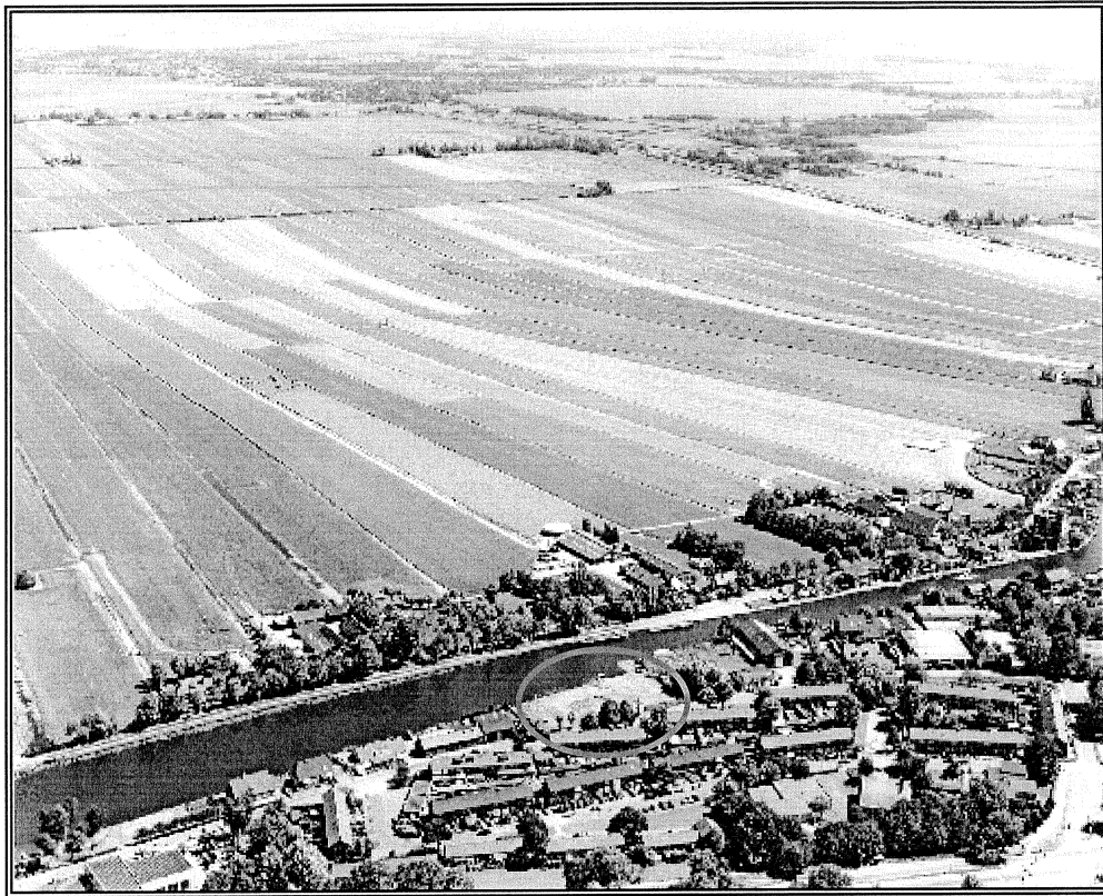
Luchtfoto 1. De onderzoekslocatie "Vinkebuurt" in de rode cirkel, op de achtergrond (noordoever) is duidelijk de overgang te zien van de stroomrug van de Oude Rijn (schuine vlak) naar het daarachter liggende lagergelegen "komklei op veen" gebied (plat vlak). (recente foto)
