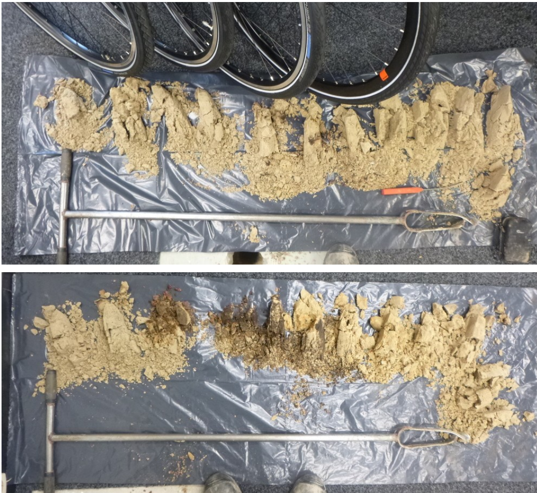
Figuur 22: Foto's van boorprofielen, boven: nr. 1, onder: nr. 2. Het ondiepste bodemmateriaal licht links (bij het handvat van de Edelmanboor).
