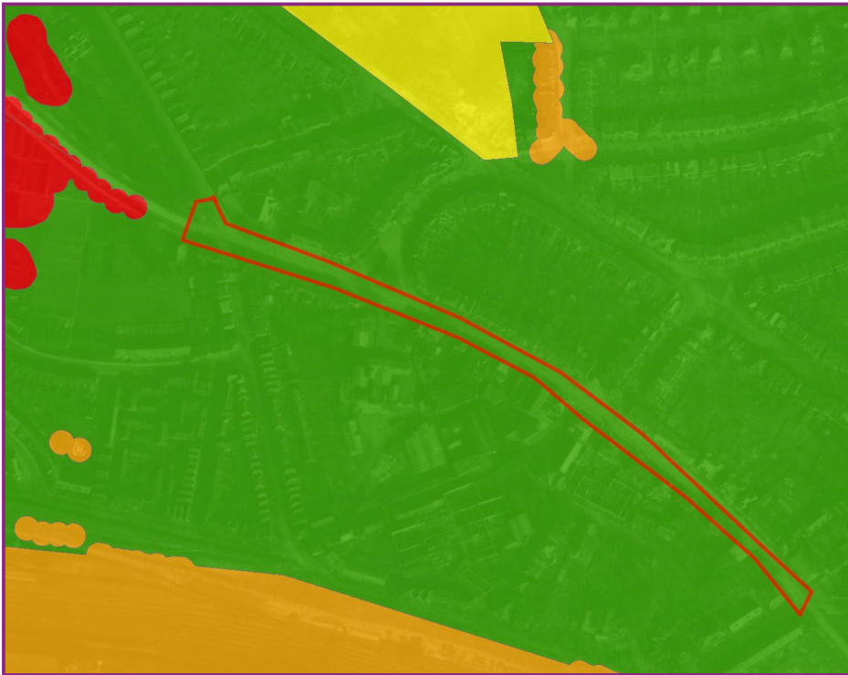
Afbeelding 13. Uitsnede van de gemeentelijke verwachtingskaart voor CE (conventionele explosieven) geprojecteerd op een luchtfoto uit 1944 met in het rode kader het plangebied (bron: Geografisch Informatiesysteem Gemeente Arnhem, nabewerkt door L. Smole).
