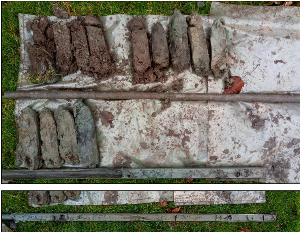
Boring 1: Boven: 0-200 cm -Mv. Onder: 200-300 cm -Mv.
