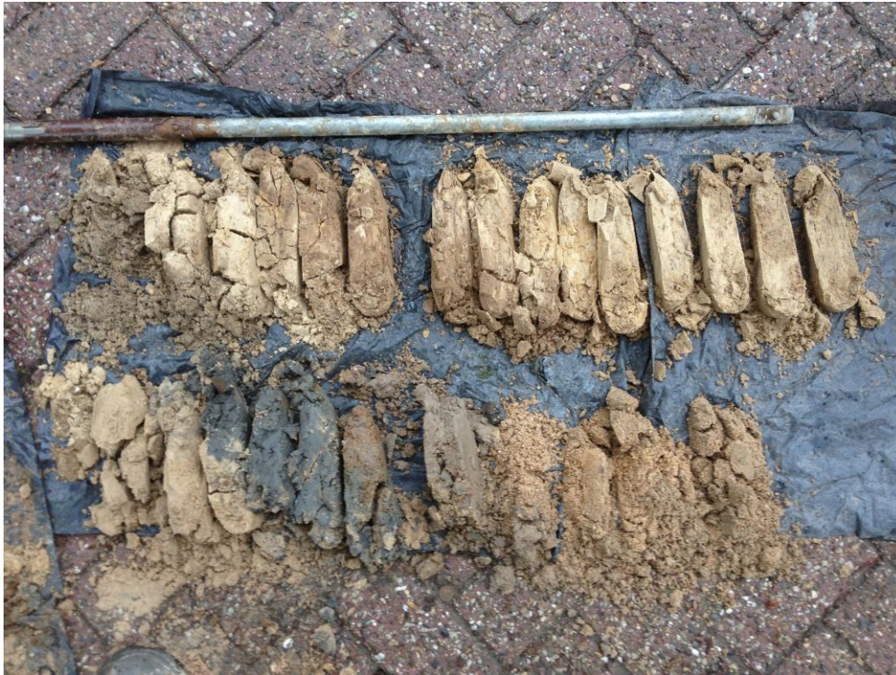
Boring 1: totaaloverzicht boorkernen
