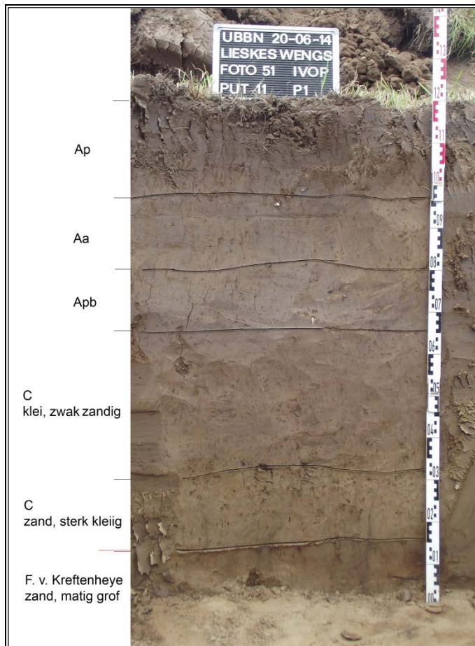
Afbeelding 11. Profielkolom ter plaatse van Proefsleuf nr. 11, met overgang van zandige klei naar kleiig zand, en vervolgens een scherpe overgang naar een laag met grof zand. Dit betreft een bodemopbouw met Afzettingen van Gorkum/Tiel 0, op (Pleistocene) Afzettingen van de Formatie van Kreftenheye.
