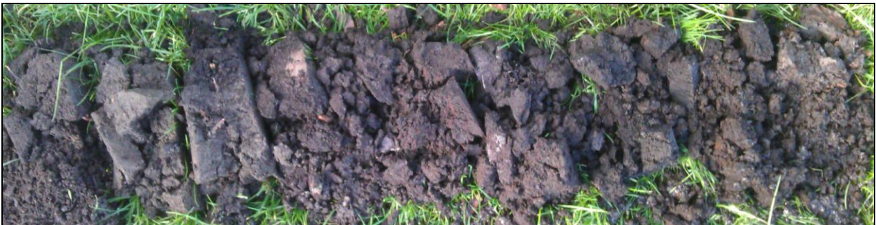
Figuur 6: boring 2 met in de top een recent ophoogpakket
