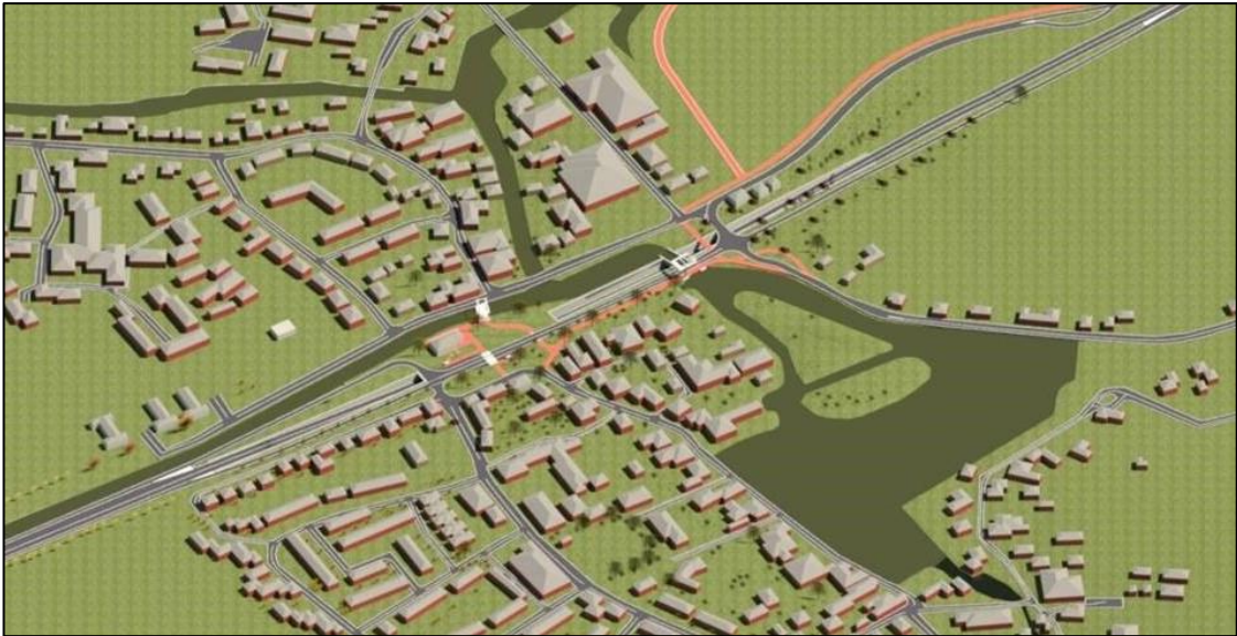
Figuur 2 Overzicht van de nieuwe situatie, waarin de N247 verdiept is. Het noorden is in deze tekening rechtsonder. De centrale weg in de tekening is de N247. Bron: Tauw bv.
