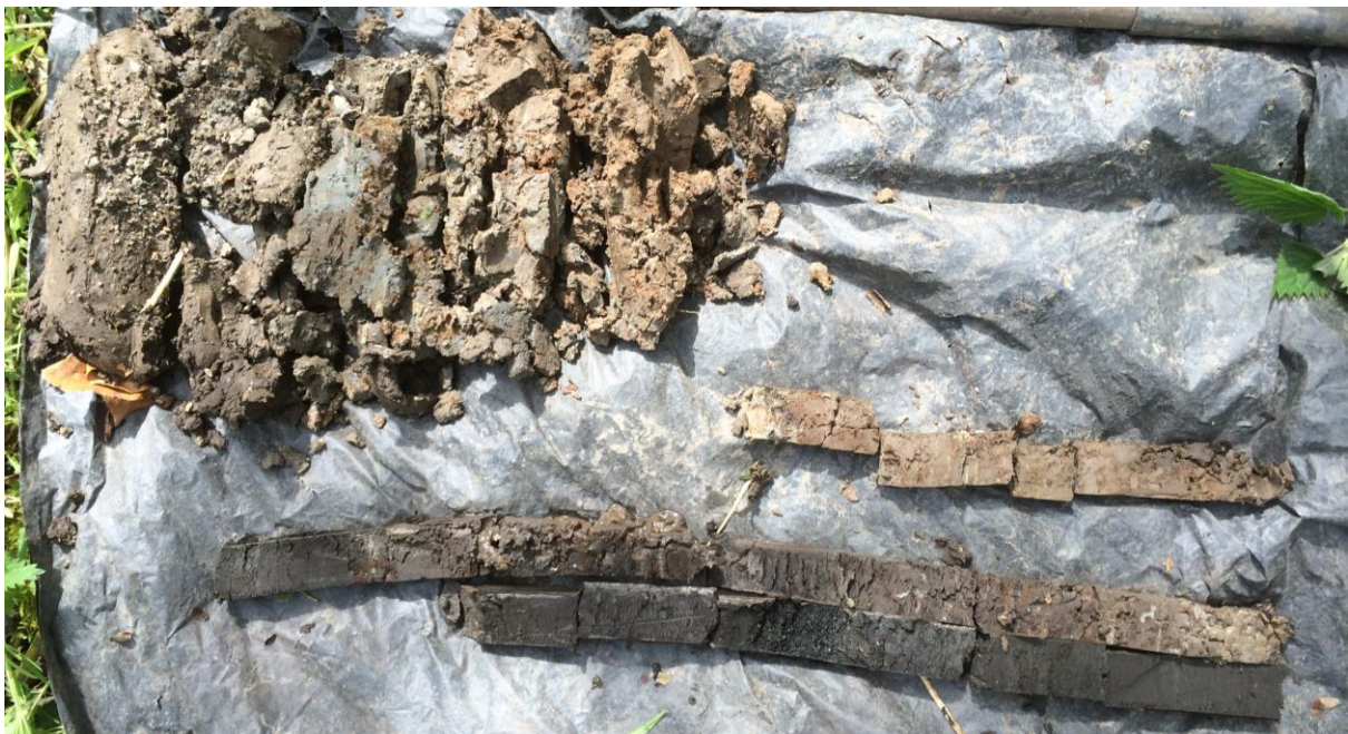
Boring 13: Overzicht boorkernen holocene deel van het bodemtraject (tot en met Almere-afzettingen rechtsonder).
