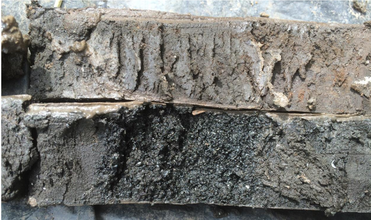
Boring 13: de korrelige laag die in de Almere-afzettingen op 170-190 cm –Mv is aangetroffen
