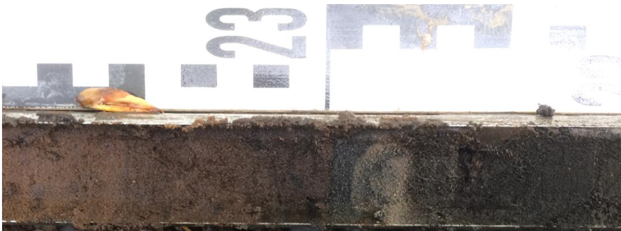
Boring 19: een scherpe overgang van een verspoeld zandbandje naar dekzand (Bhs)
