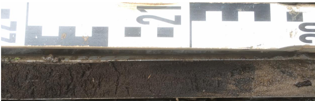
Boring 15: Overgang van verspoeld zand (rechts) naar dekzand (Bh-horizont) links
