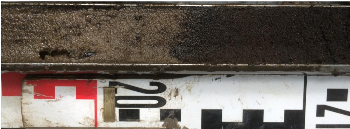
Boring 11: Overgang van verspoeld zand (links) naar dekzand (Bh-horizont) rechts
