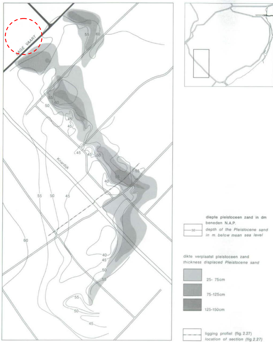
Fig. 2.26. Diepte van de pleistocene opduiking "de Knar" en dikte van het verplaatste pleistocene zand
