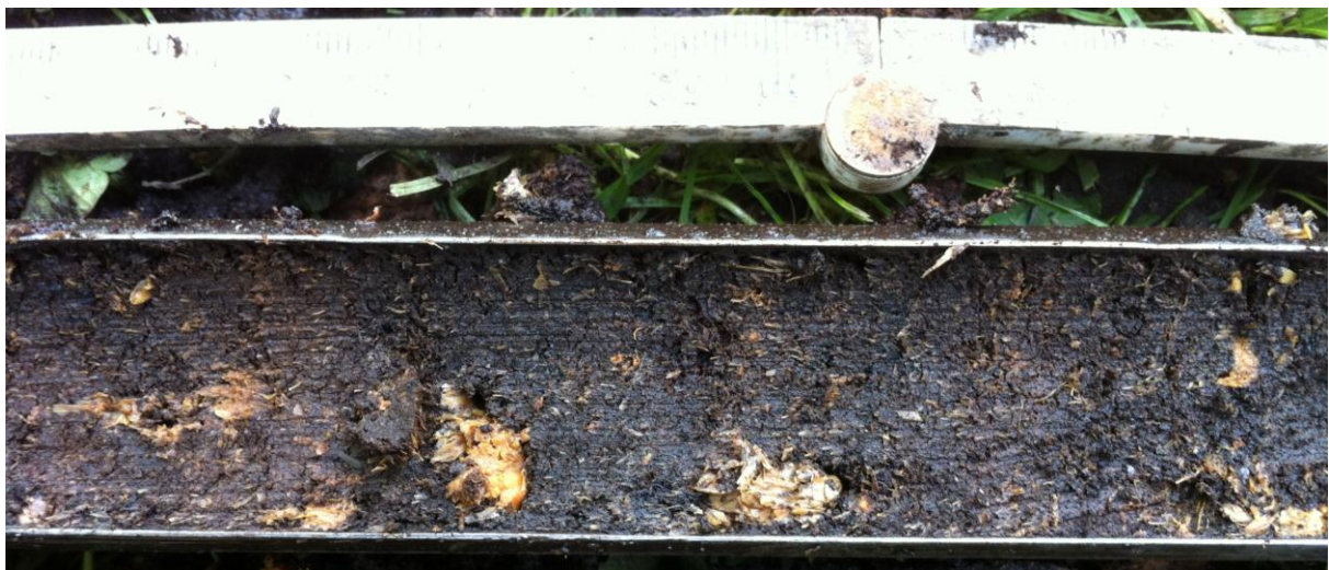
Boring 1: 215 – 375 cm –Mv: mineraalarm veen met rietstengels.
