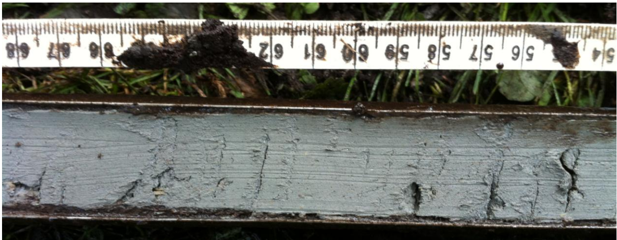
Boring 1: 440 – 465 cm –Mv: matig siltige Wormerlei.
