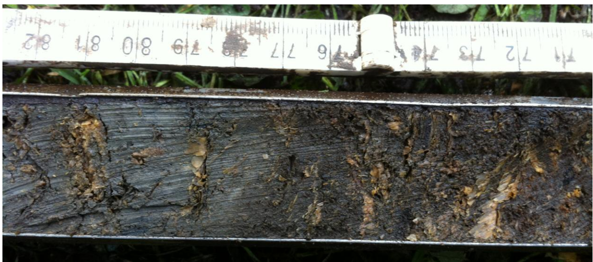
Boring 1: 350 – 400 cm –Mv: overgang mineraalarm rietveen naar zwak siltige slappe Wormerklei.
