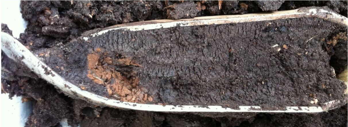
Boring 1: 100 – 135 cm –Mv; venig ophogingspakket met een stuk hout.
