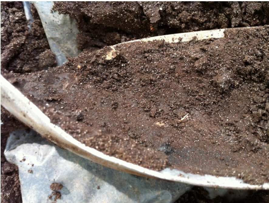
Boring 1: Detail boorkern traject tussen 40 – 100 cm –Mv: zwak zandig zeer compact veen, met veel uitgeloopte zandkorrels en matig veel houtskool.
