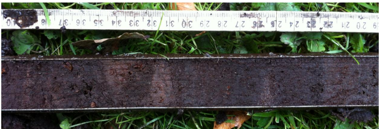
Boring 1: 135 – 190 cm –Mv; mineraal arm veen met hout (dunne takjes).
