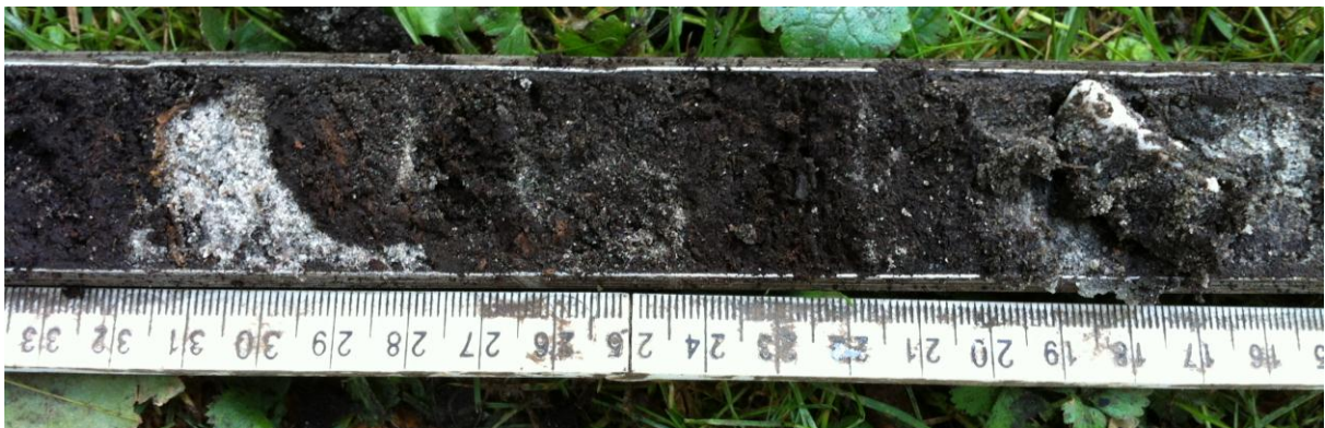
Boring 1: 100 – 135 cm –Mv; zandlensjes van sterk uitgelopen zand in het ophogingspakket. Rechts is een kwartsgrind in de guts zichtbaar.
