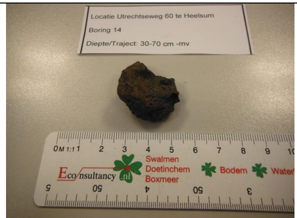
Boring 14: ijzerslak/vloeslak, niet determineerbaar
