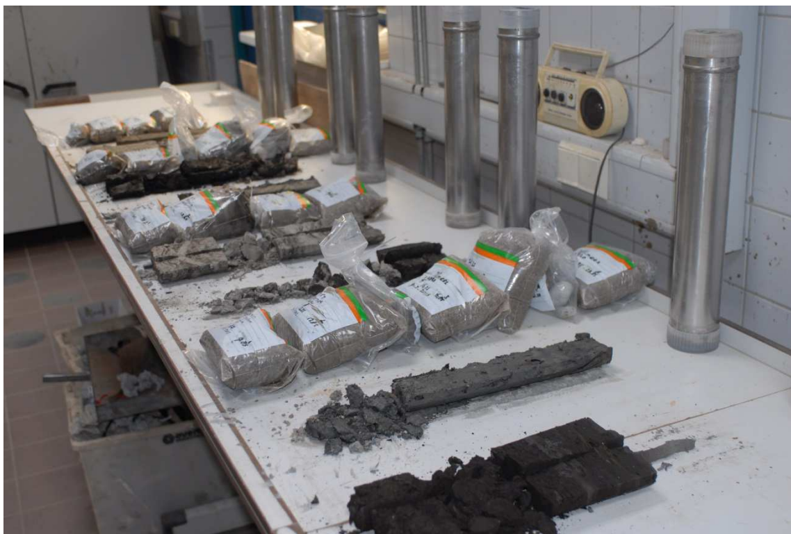
Afbeelding 8 De meng- en steekmonsters uit de vier diepe boringen in het laboratorium van Fugro in Arnhem. Bron: foto Vestigia.
