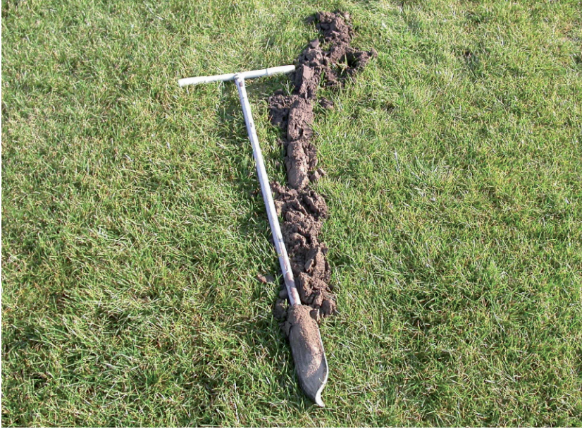
Afbeelding 2.4: uitleg van één van de boringen uit de inventarisatie. Onderin in de edelmanboor is de top van het duinzand zichtbaar.
