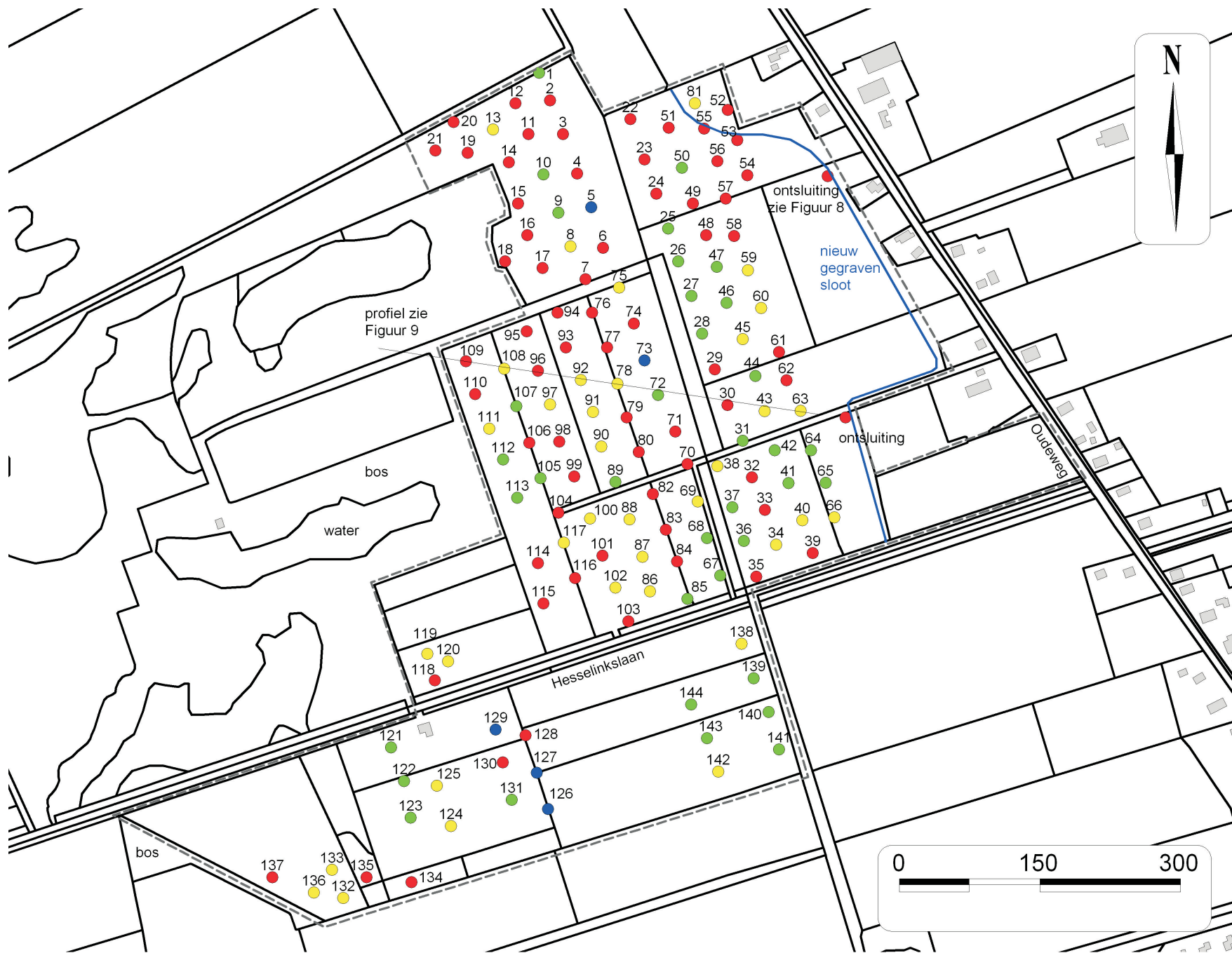
Figuur 7: Boorpuntenkaart Westerbroek: Hesselinkslaan. De stippen geven boorpunten weer. De kleuren hebben de volgende betekenis: rood = tenminste B-horizont intact; geel = B-horizont verstoord, BC intact; groen = B en BC verstoord; blauw = te nat voor podzolering
