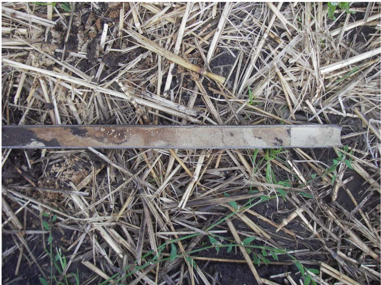
Figuur 16: Foto van de door verploeging verstoorde laag of AC-horizont zoals deze in nagenoeg alle boringen tussen de bouwvoor (links) en het schone lichtgele zand van de C-horizont (uiterst rechts) is aangetroffen.
