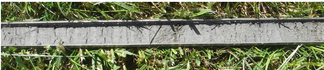
Figuur 8. Dokkum, Zonnepark. Het pakket matig slappe, door talrijke zandlaagjes onderbroken klei zoals dat onderin veruit de meeste boringen is aangetroffen.
