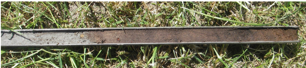
Figuur 9. Dokkum, Zonnepark. De verspoelde top van het dekzand zoals deze onderin de boringen 13 en 40 is aangetroffen (rechts).
