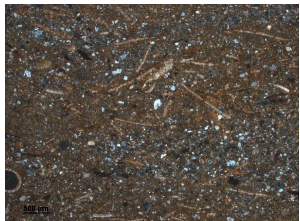
5.6 Sediment matrix met veel schelp-/molluskfragmenten (XPL)
