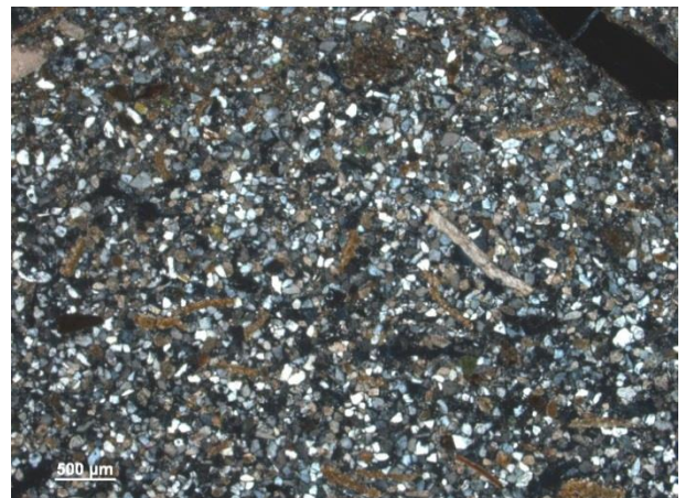
3.6: Zandige grondmassa in het bovenste deel van het monster (mf I) (XPL)
