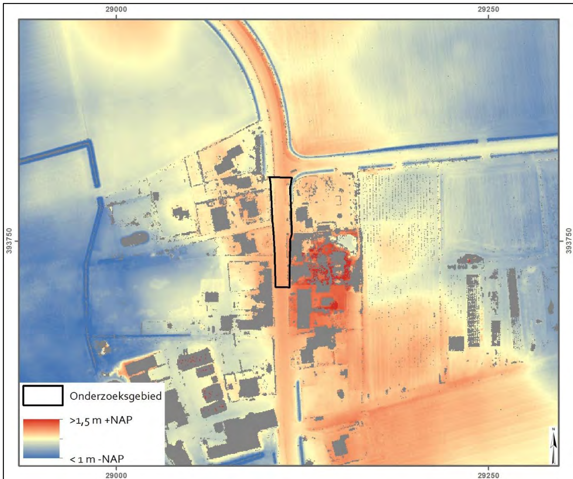
Afbeelding 11 Projectie van het onderzoeksgebied op een uitsnede van het Actueel Hoogtebestand Nederland (AHN3). Waarden hoger en lager dan 1,5 m + NAP en 1 m -NAP zijn egaal ingekleurd. Schaal 1:2.500. Bron: AHN.
