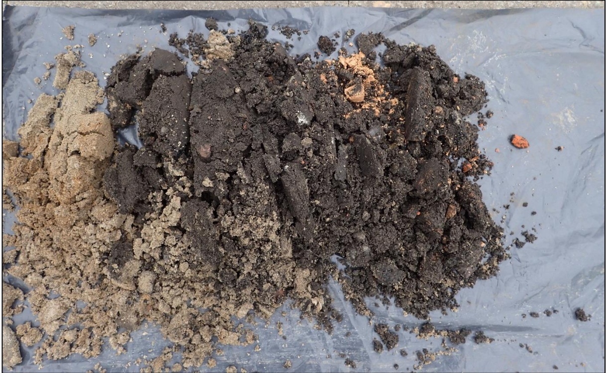
Boring 5: 0-50 cm –Mv. Gestaakt in puin.
