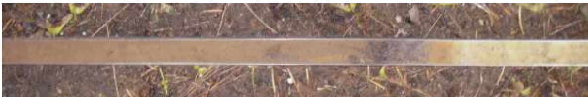
Figuur 14: Foto van boring 6 met in het midden de overstoven toplaag, rechts daarvan het pakket geel zand met verbruiningsbandjes en links het volledig verbruinde zand dat onderin de boringen is aangetroffen.
