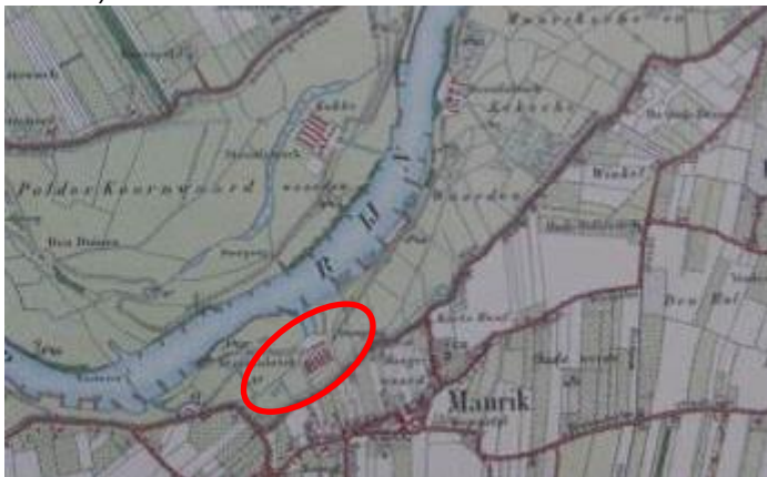
Afb. 17: De Polder Koornwaard en de Mauriksche en Ecksche Waarden. Door bekrassing aan weerszijden is de loop van de Rijn vrijwel vastgelegd. (Bron: 1900 Topografische kaart, 1:25.000)
