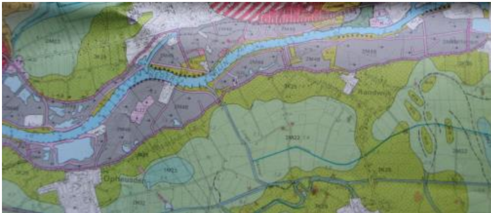
Afb. 121: De meeste uiterwaarden zijn afgegraven. Duidelijk komen de pre-Romeinse stroomruggen naar voren (code 3K25). (Bron: 1986 Brus)
