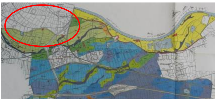
Afb. 25: Noordelijke deel van de geologische kaart van de landinrichting Ochten-Opheusden; geel: uiterwaardafzettingen, lichtgroen: middeleeuwse stroomgordel (Marspolder); groen: pre-Romeinse stroomgordel (Kesteren) en een aftakking van de Romeinse Rijn bij Opheusden richting Ochten. Blauw: bronstijd stroomgordel bedekt met komlei, paarsblauw: komafzettingen al dan niet op veen. (Bron: 1992 Mulder et al, 1:25.000)
