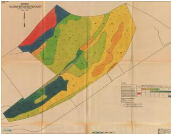
Afb. 8: Klei-inventarisatie Rijswijk (terrein ligt buiten meandergordel Neder-Rijn). Rood: vergraven; donker blauw: restbedding. Kleidiktes: oranje: 10-15 dm, geel: 15-20 dm en groen > 20 dm. De ronde lijn aan de bovenzijde is de oude rivierarm. (Bron: 1967 Steeghs. 1:1000)
