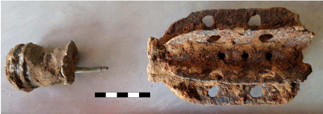
Afbeelding 7 Het aangetroffen staartstuk en ontsteking van de 3-inch mortiergranaat. Bron: foto Vestigia (12-09-2017).
