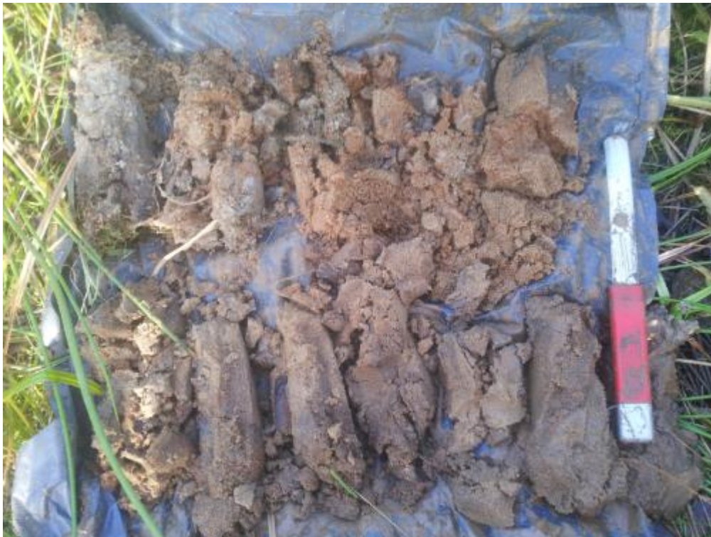
Boring 7: Overzicht boorkernen (uitgelegd van linksboven naar rechtsonder).
