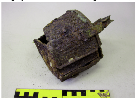
afbeelding 69, ijzeren patroonhouder voor een Machinengewehr (MG 34).
