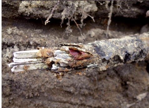
afbeelding 34, stroomkabel van aluminium met een isolatie van geolied papier.
