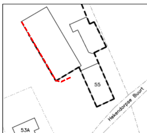
Afbeelding 7. Schets van de ligging van de leidingsleuf, aangegeven met de rode stippellijn
