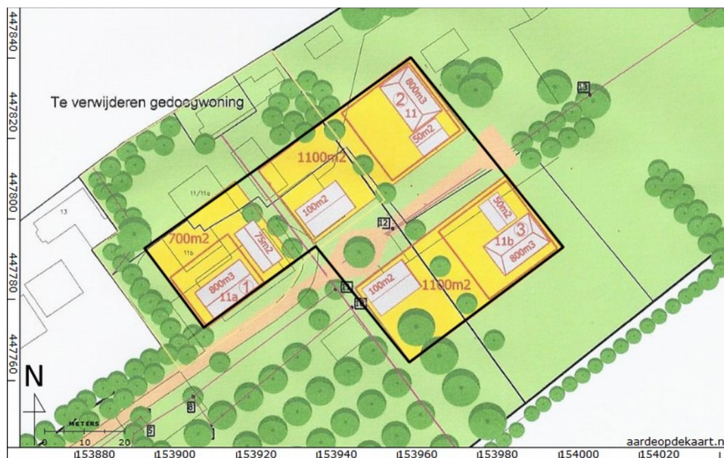
Figuur 2: De geplande ontwikkeling. De dikke zwarte lijn is het plangebied. Het roze vlak is de toegangsweg, de drie nieuwe bouwblokken zijn in het geel weergegeven met een rode rand. De geplande nieuwe bebouwing zijn als witte vlakken weergegeven en de huidige bebouwing is aangegeven door de dunne zwarte lijnen.
