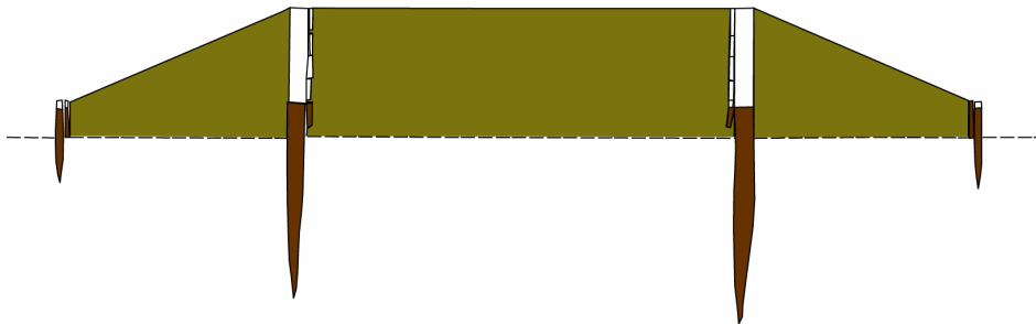
Afb. 9. Dwarsdoorsnede van de Romeinse weg bij Valkenburg (ZH) op het Marktveld (Naar De Hingh/Vos 2005).
