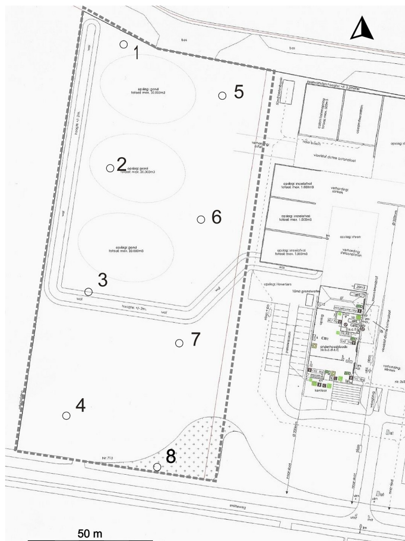
Figuur 5. Ballum, Smitteweg 15. Boorpuntenkaart. De genummerde punten geven de uitgevoerde boringen weer. [Bron: W2N Engineers.]
