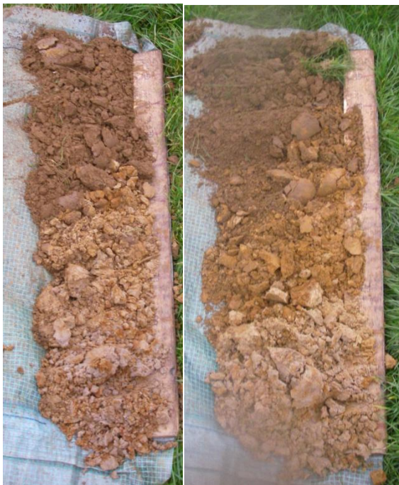
Fig. 3.1: Foto's van de opgeboorde profielen met aan de linkerkant een beekerdgrond en aan de rechterkant een veldpodzol.
