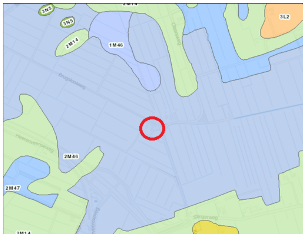
Afbeelding 5. Geomorfologische kaart met het onderzoeksgebied omcirkeld. De kern van het gebied ligt op een dekzandwielving, code Hn21 (veldpodzolgronden; leemarm en zwak lemig fijn zand) (bron: https://zoeken.cultureelerfgoed.nl ).
