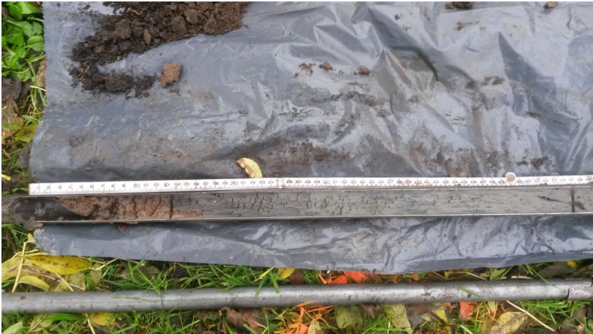
Boring 6: deel van een geulvulling.
