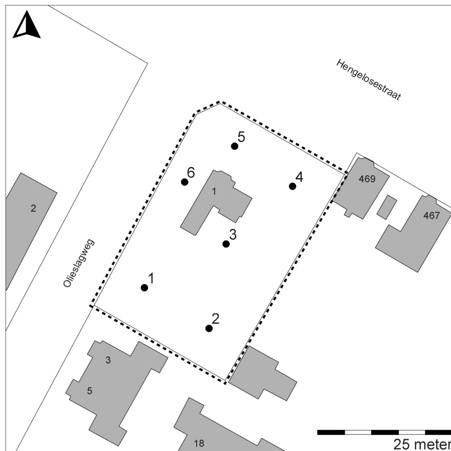
Figuur 7: Enschede, Olieslagweg 1: boorpuntenkaart. Het onderzoeksgebied is aangegeven door een onderbroken lijn. De genummerde punten geven de ligging weer van de zes boringen.
