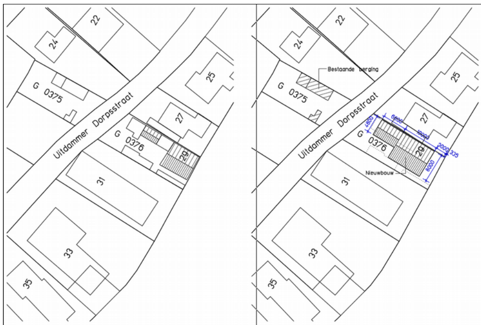
Afbeelding 2. Bouwkundig plan, de huidige situatie is links weergegeven, rechts is het plan voor de toekomstige situatie te zien. (door de opdrachtgever geleverd ontwerp van Rolf Botman, 07-08-2017).
