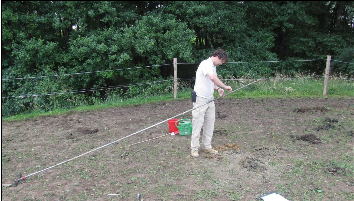
Figuur 45: Plaatsing van boring 940 onderin het beekdal. De huidige beekloop onder de begroeiing op de achtergrond heeft zich diep in de dalsedimenten ingesneden. Het oorspronkelijke hellingprofiel is door middel van recente ophoging geëgaliseerd en vlak getrokken.
