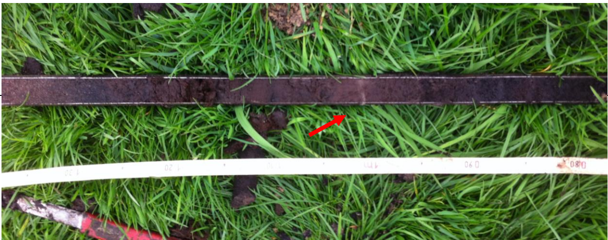
Opname van boring 3: Detritus (verslagen veen) met daarin een dun kleilaagje
