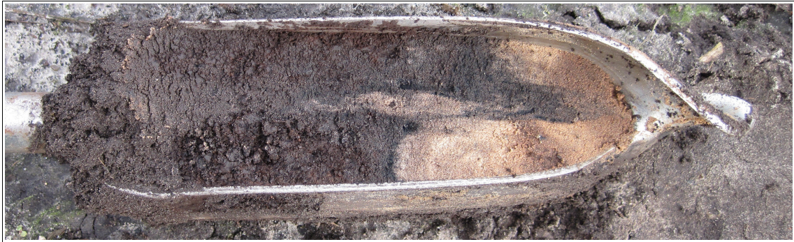
Figuur 10: Nieuwe Pekela, Doorsneeweg: monster boring 17 van 40 tot 53 centimeter diepte. Links in de boorkop ligt donkerbruin veen, rechts ligt bruingeel zand. Op de overgang tussen beide is een dunne zwarte laag sterk amorf veen zichtbaar. Het zand vertoont nauwelijks tekenen van bodemvorming. In de top direct onder het veen is enige verbleking opgetreden, daaronder is enige humus ingespoeld ten tijde van de veenontginning in de tweede helft van de zeventiende eeuw. Deze inspoelingshorizont heeft dus niets te maken met podzolering.
