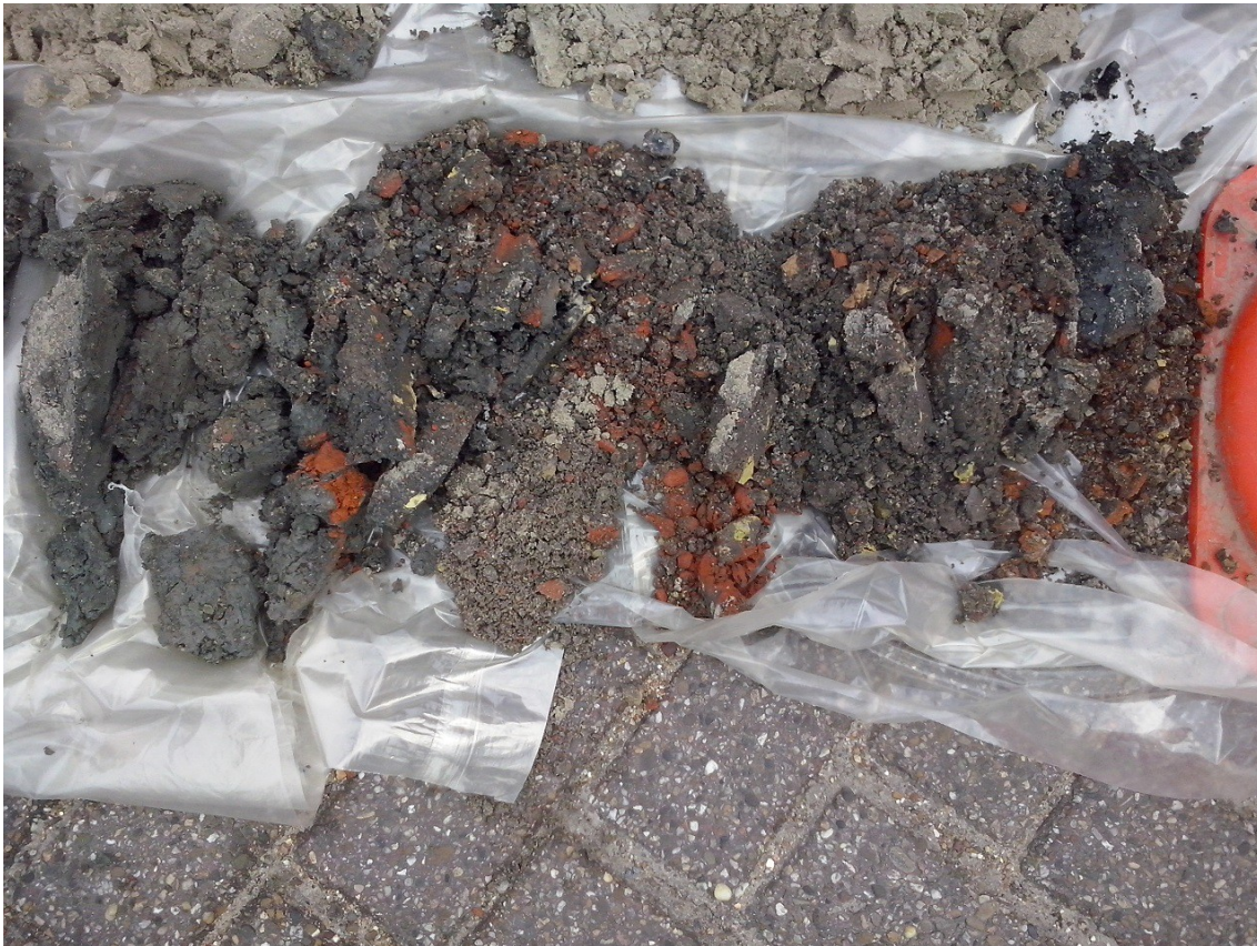
Figuur 4. Franeker, Oud Kaatsveld 11-31. Foto van milieuboring 2 met boven (nog net te zien op de foto) het bestratingszand en onder het met slooppuin vermengde kleipakket.
